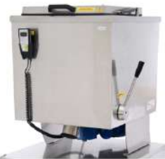
Fig. 1. Malaxor pentru pregătirea nămolului cu perete dublu din inox și încălzire prin ulei pentru un transfer de căldură uniform
